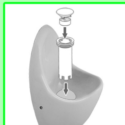
Siphoneinsatz wieder einsetzen.
